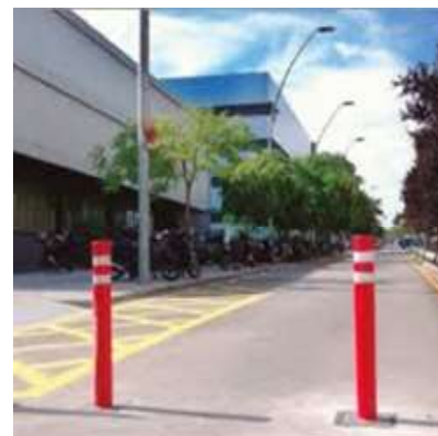
Figura 1. Fita de protecció mecànica
